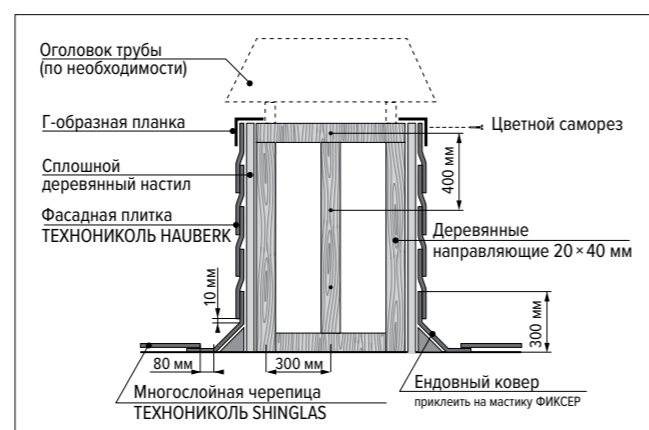
Рис. 26. Монтаж фасадной плитки на вентиляционную трубу
