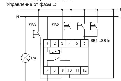
SB1...SBn - кнопочный выключатель управления «Включение - Отключение» нагрузки;
