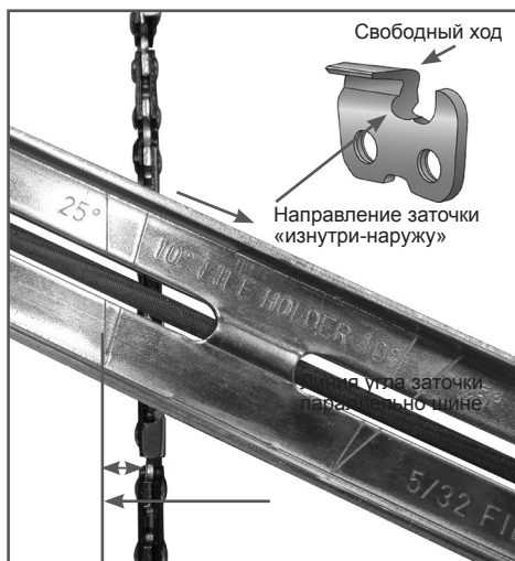
Рис. 22 Расположение линии угла заточки
