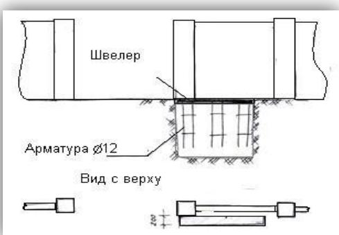
Обратите особое внимание на уровень расположения верхней плоскости закладного элемента. От того на каком уровне, по высоте, Вы установите закладной элемент, будет зависеть зазор от дорожного полотна до нижней кромки ворот. Т.е. если Вы установите закладной элемент вровень с уровнем дорожного покрытия, то при
