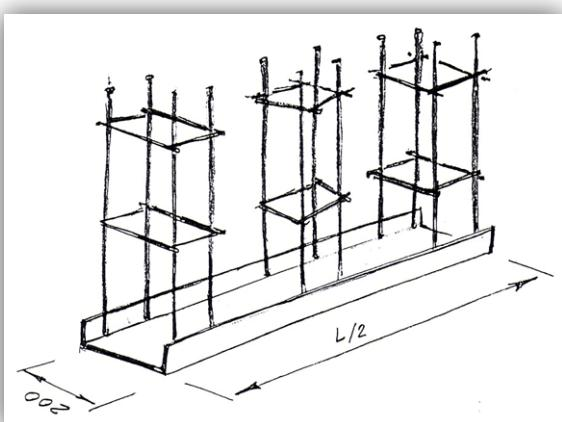
Далее привариваем поперечные связи из той же арматуры (см. рисунок).
