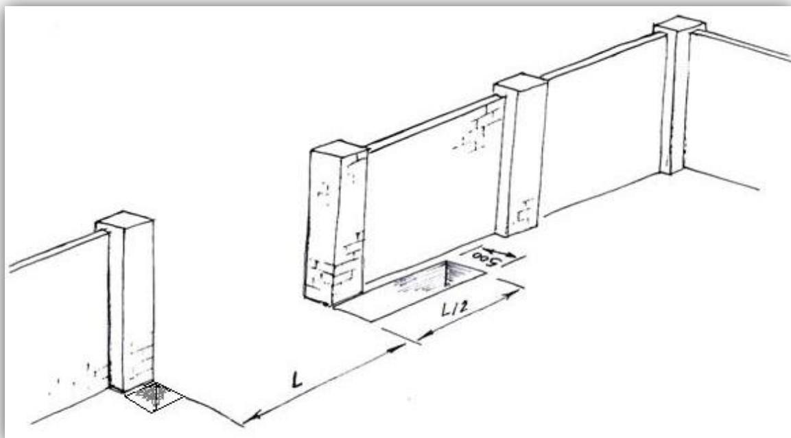
В случае, если столбы забора не могут быть использованы в качестве опорных для откатных ворот, необходимо, с противоположной стороны проема, напротив ямы под бетонное основание, разметить яму под ответный столб. Яма должна быть расположена таким образом, чтобы установленный в ней столб мог примыкать к линии забора изнутри и не заужать проема.
