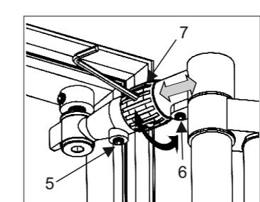
Затяните фиксирующие винты. Те же действия проделайте со вторым рычагом сбоку, то же направление вращения и угол поворота. Дверца смеется параллельно в сторону (Рис 8).
