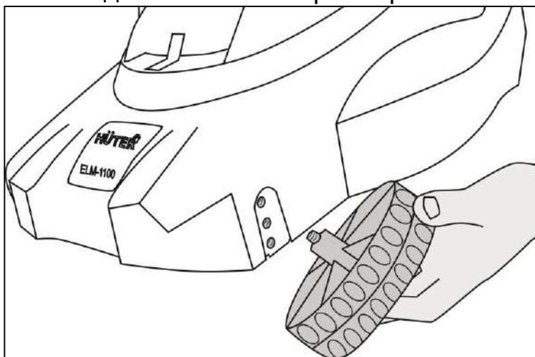
Рис.11. Регулировка высоты среза для каждого колеса отдельно
