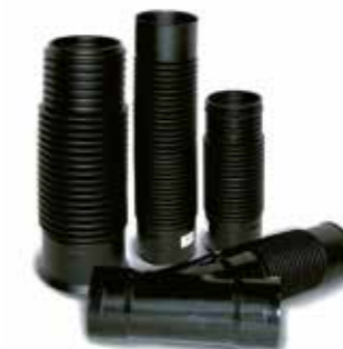
Повороты и ответвления трубопровода осуществляются при помощи гибких фитингов – отводов и тройников. В муфтовых соединениях уплотнительные кольца не используются.
