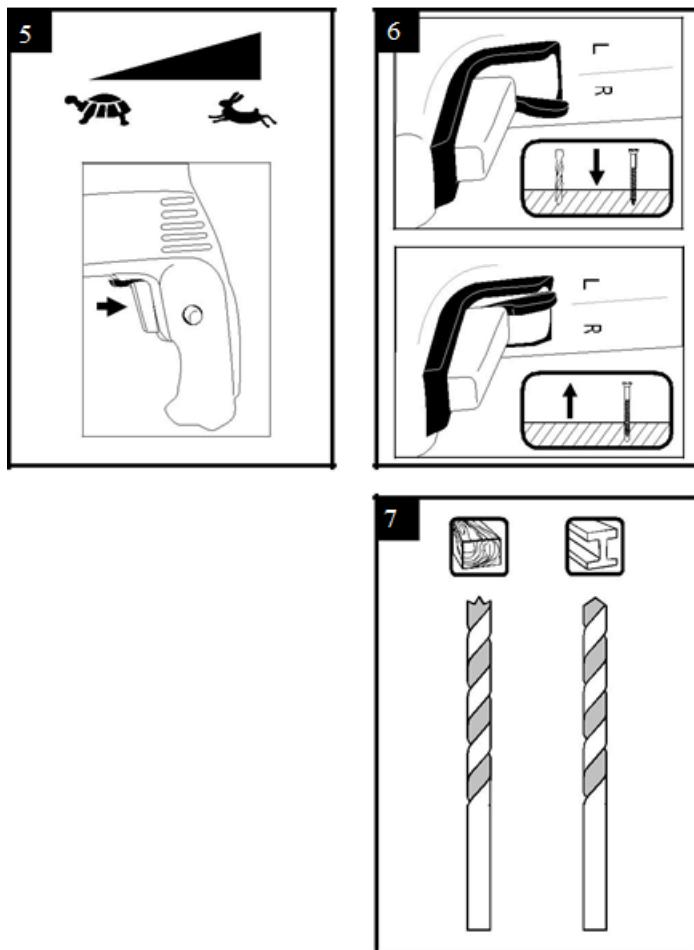
Регулировка скорости вращения (рис. 5) Скорость вращения регулируют при помощи давления на выключатель дрели – чем больше давление, тем выше скорость.
