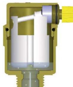
При наличии воздуха уровень воды опускается и поплавок открывает затвор
