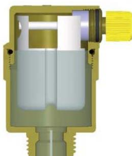
При отсутствии воздуха в системе вода поднимает поплавок до полного закрытия затвора
