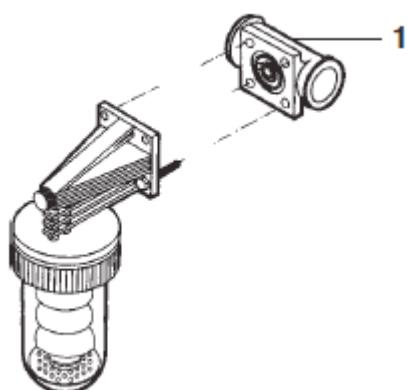
Сделать врезку в трубопровод, при необходимости уменьшить размер трубы соответственно размеру датчика давления (1). Установить датчик горизонтально или вертикально. Стрелка указывает направление потока воды. До и после аппарата установить запорные клапаны.
