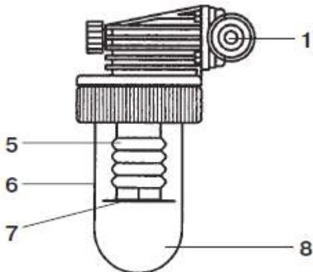
В датчике рабочего давления (1) с измерительной диафрагмой создается дифференциальное давление, позволяющее откачивать от основного потока воды пропорциональную часть и отвести ее через сильфон (5) в прозрачный стакан (6), содержащий порошок активного вещества (8). Одновременно с этим в основной поток воды дозируется пропорционально расходу соответствующее количество растворенного активного вещества. Сильфон (5) движется вместе с понижающимся уровнем активного вещества.
