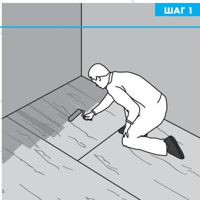
Перед установкой плиты поверхность черного пола должна быть обработана грунтовкой АКВАПАНЕЛЬ® (1:1). Время высыхания – полдня.
