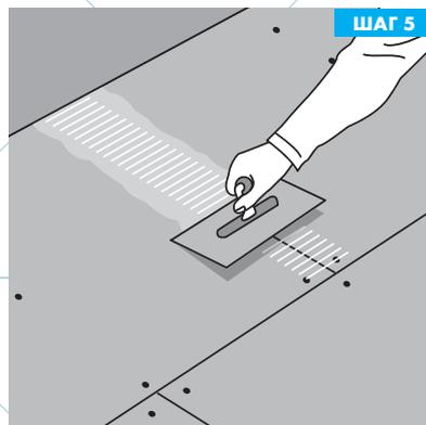
После монтажа плит все стыки заполняются плиточным клеем КНАУФ-Флекс (класс C2/S1 по EN 12004 / 12002) с использованием армирующей ленты шириной 10 см, которая укладывается по центру шва в свеженанесённый клей.
