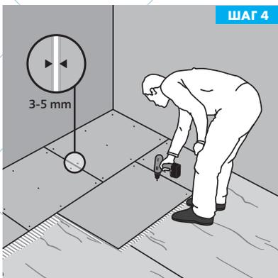
Сразу после установки плиту необходимо закрепить шурупами АКВАПАНЕЛЬ® Шурупы с острым концом SN. Шурупы не должны проворачиваться.
