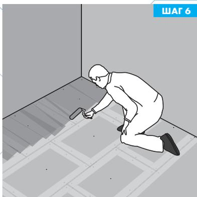
Перед укладкой керамической плитки поверхность необходимо загрунтовать АКВАПАНЕЛЬ® Грунтовка (1:2). После высыхания грунтовки (~8-12 часов) можно приступать к укладке керамической плитки.
