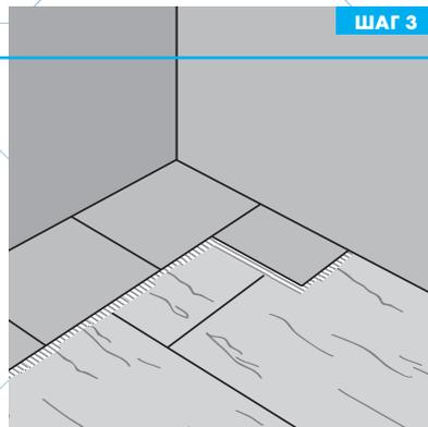
От угла помещения устанавливается плита с разбежкой швов между плитой и черновым основанием не менее 200 мм. Между плитами необходимо оставлять зазор 3-5 мм.
