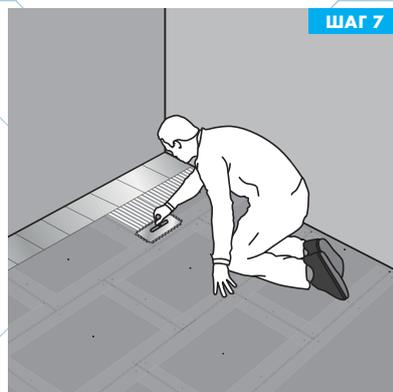
Укладку плитки рекомендуется производить на плиточный клей КНАУФ-Флекс (класс C2/S1 по EN 12004 / 12002). Максимальный размер плитки 33x33 см. При превышении размеров необходимо использовать демпфирующую подложку.
