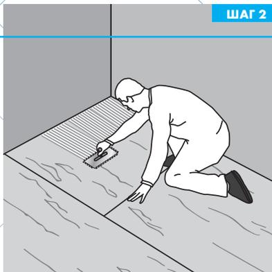
На просушенную поверхность деревянного настила наносится плиточный клей КНАУФ-Флекс (класс C2/S1 по EN 12004 / 12002). Возможно крепить плиты на поверхность деревянного настила без использования клея. В этом случае шаг шурупов должен быть уменьшен до 100 мм.
